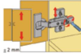
Con suplementos de altura regulable puede alinearse exactamente la posición de altura de las puertas.
