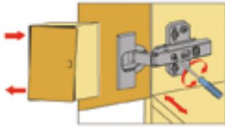
Girar el tornillo hacia la derecha para reducir la solapadura de la puerta (-). Girar el tornillo hacia la izquierda para incrementar la solapadura de la puerta (+).
